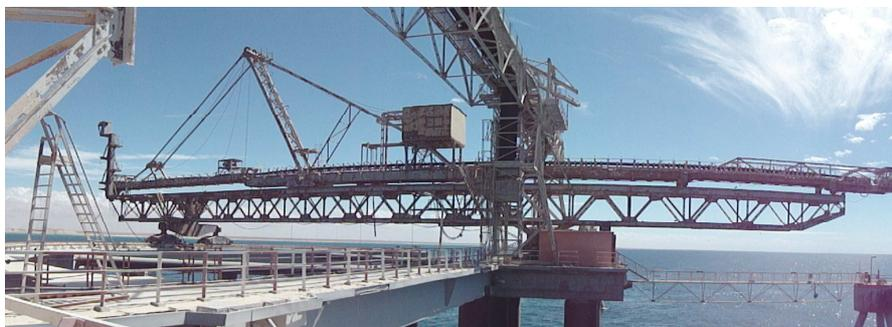
Les quais de chargement à l'extrémité de l'ouvrage, sont équipés de machines de chargement de phosphate. Ces machines reposent sur une poutre treillis de 100 m de long et 400 T de poids total.
