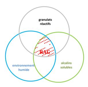
Les alcalins sont apportés par les constituants du béton (essentiellement le ciment) et l'environnement extérieur (exposition à l'eau de mer ou aux embruns marins, aux sels de déverglaçage).
