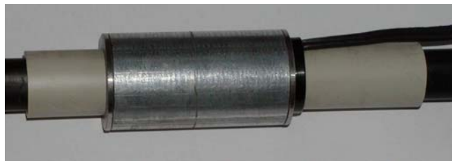
Fig.16 EM sensor PSS20 for MONOSTRAND
