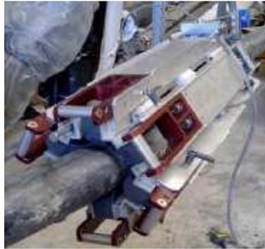
Sur les câbles TMC, MTP (selon gainage) Permet de trouver les zones de corrosion et les fils rompus.
