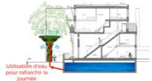
Repompages de l'eau grâce à l'énergie produite à perte la nuit
