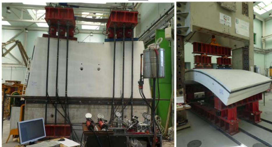
**FIGURE 6 ESSAI DE CHARGE VERINS DE POUSSE TBM ET ESSAI DE FLEXION**
