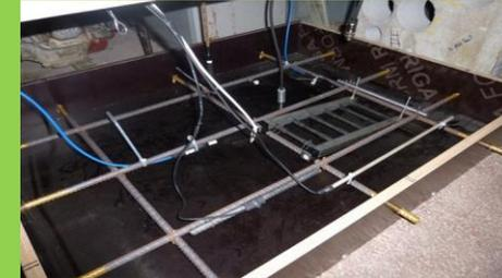
Capteurs : HMP110, ERE20, MultiRingElectrode, Anode Ladder, Centrale d'acquisition (Ibac)
