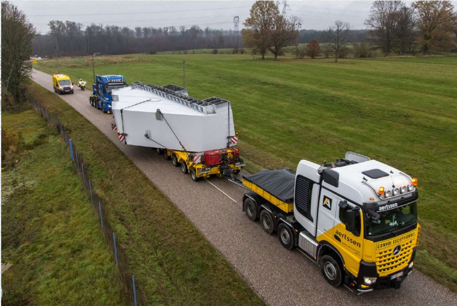
Poutre de 120 ton
