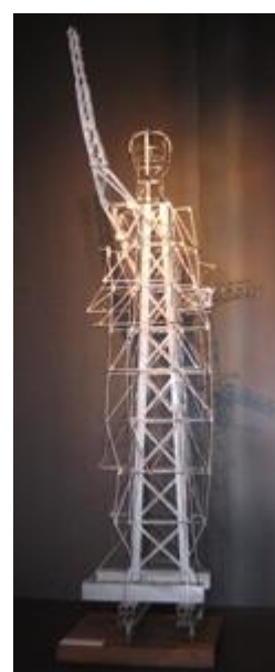
Maquette de l'ossature de la statue de la Liberté à New York
