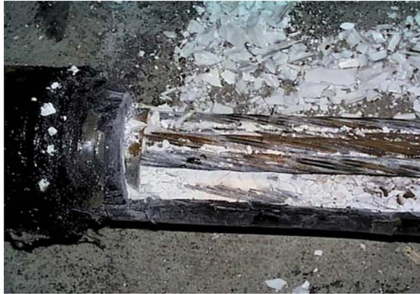
**Figure 2.47.** Pâte blanchâtre et câble corrodé (DDE).
