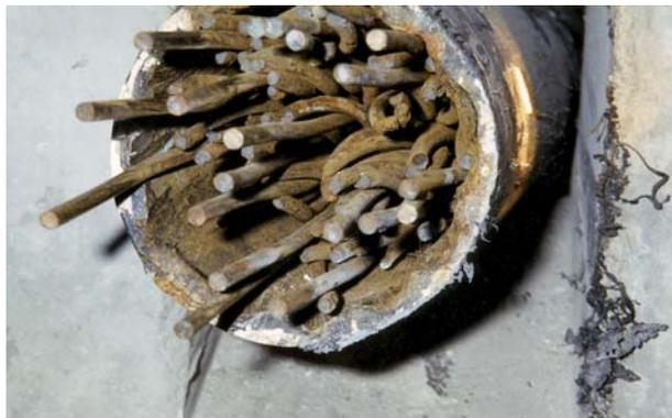
**Figure 2.48.** Rupture par corrosion d'un câble du viaduc de Val-Durance. Noter la conjugaison de ruptures anciennes et plus récentes (D. Poineau).
