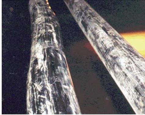
**Figure 2.51.** Gaine en PEHD déformée (D. Poineau).
