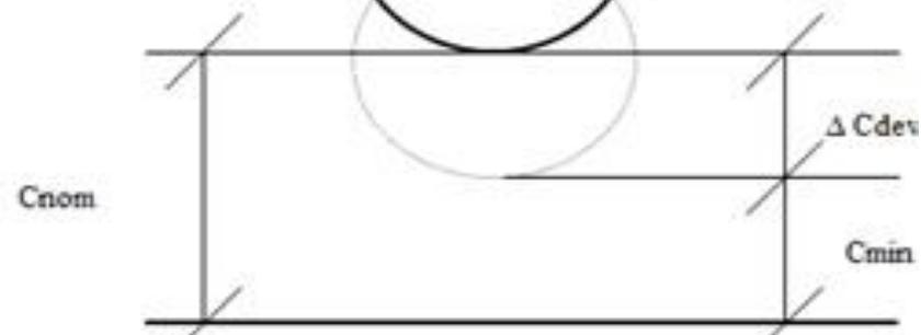
**Seul l'enrobage nominal est précisé sur les plans d'exécution**, en tant que référence pour la fabrication et pour la pose des armatures.
