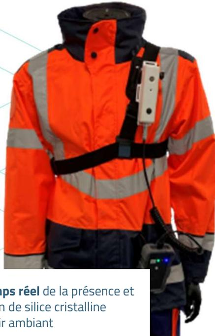
**Être alerté en temps réel** de la présence et de la concentration de silice cristalline alvéolaire dans l'air ambiant
