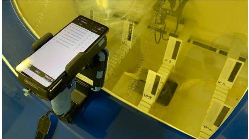
**NF EN ISO 16701** - Corrosion des métaux et alliages - Corrosion en atmosphère artificielle - Essai de corrosion accéléré comprenant des expositions sous conditions contrôlées à des cycles d'humidité et à des vaporisations intermittentes de solution saline
