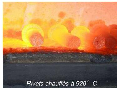
Rivets chauffés à 920° C
