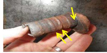
Etat d'un rivet de l'attache, empreinte du mouvement et tête excentrée
