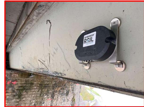
Capteur « Probe 2 » de la solution Ad-Signum
