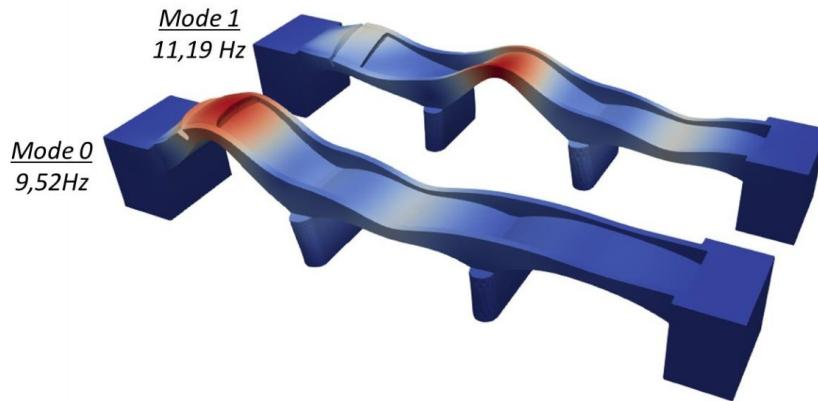
Bonne convergence des mesures avec le modèle avec diminution des fréquences propres au gré du chargement.
