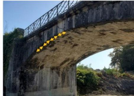
Six capteurs de déplacement potentiométriques.
