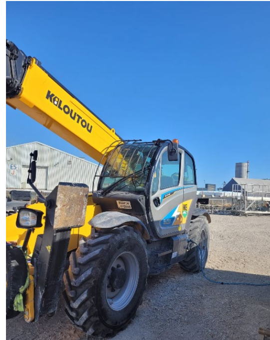
Chantier test chariot élévateur Rétrofit thermo reconverti en électrique
